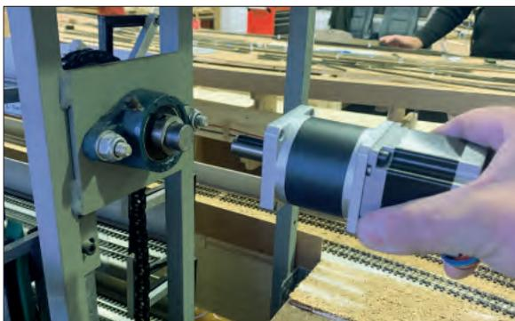
An jeder Seite des Paternosters musste eine Halterung gebaut werden, um die Schrittmotoren an die Antriebswelle anflanschen zu können.
