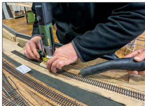
Um das Magnetband präzise verlegen zu können, wurde eine Oberfräsen-Führung für H0-Gleise entwickelt.
