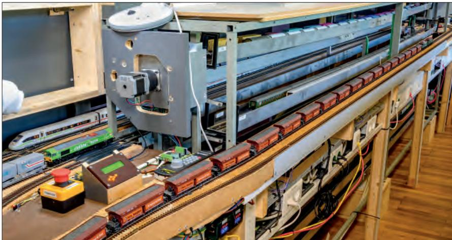
Der mächtige Paternoster bietet 15 Schubladen mit je zwei 3,6 Meter langen Abstellgleisen. Angetrieben wird er über zwei Schrittmotoren. Rechts: Testaufbau mit einem der Schrittmotoren mit 50:1-Getriebe. Programmiert und gesteuert werden sie durch die...
